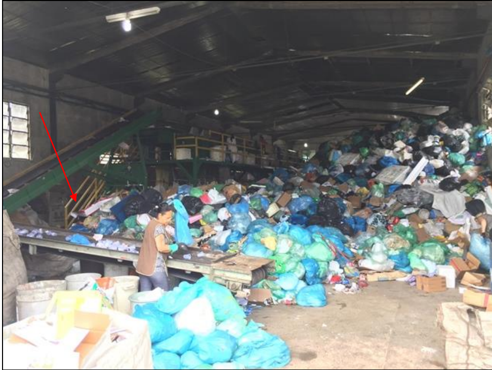
Figura 71 – Unidade de Reciclagem da RECICLA (esteira) Fonte: Premier Engenharia, 2019.
