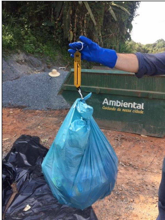
Figura 11 – Pesagem de cada componente das amostras (30/10/19) Fonte: Premier Engenharia, 2019.
