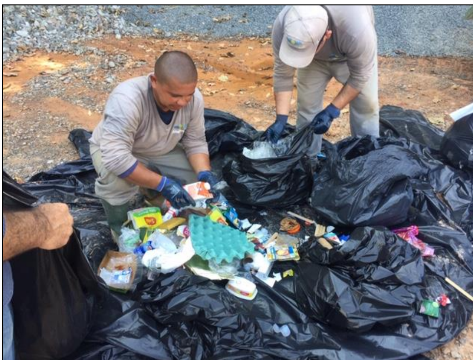
Figura 10 – Triagem dos resíduos da amostra da coleta seletiva (30/10/19) Fonte: Premier Engenharia, 2019.
